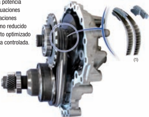
(1) 2 poleas de diámetro variable que se encuentran en el mecanismo ligadas entre ellas por una correa de acero. (se refiere a un dibujo)
